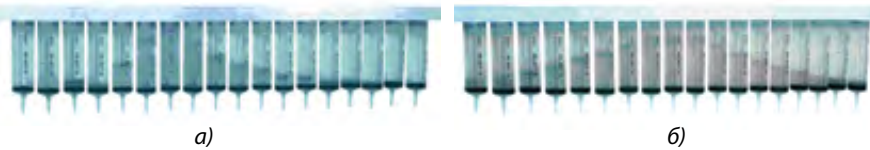
Рис. 1. Фрагменты фотоизображений распределения жидкости в мерных стаканчиках в продольном (а) и поперечном (б) направлениях действия воздушного потока на факел распыляемой жидкости
