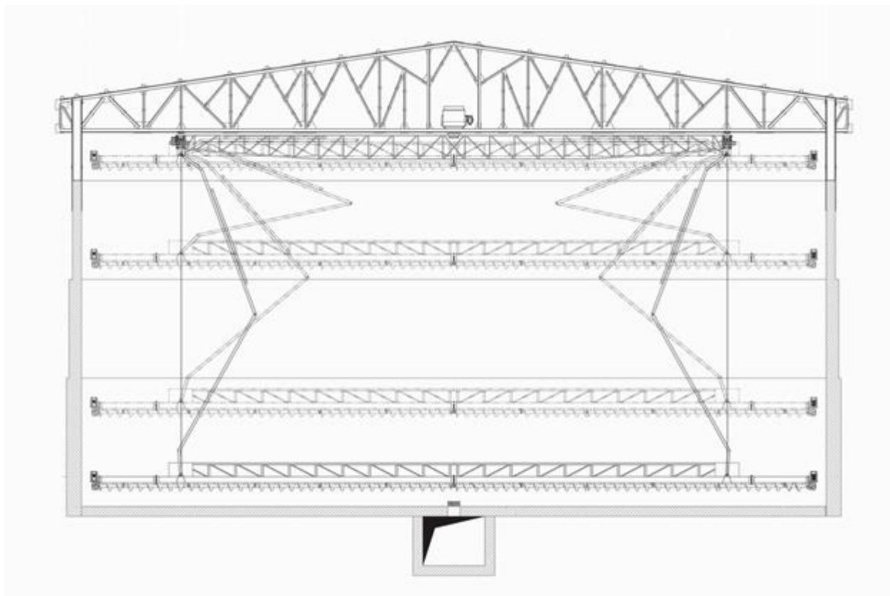
Здание зернохранилища разделено на отсеки ж/б стенами, что позволяет хранить различные по виду и качеству культуры. Металлический каркас представляет собой поперечные рамы, развязанные в продольном направлении связями по фермам и прогонам. В ферме проходит конвейерная эстакада. Ферма воспринимает нагрузки от нивелировщика, подвешенного к нижнему поясу.
