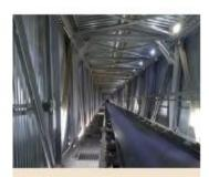
Ленточные конвейеры Ширина ленты от 300 до 2000 мм Длина трасс до 500 м
