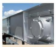
Цепные конвейеры горизонтальные и наклонные Производительность от 20 до 600 т в час
